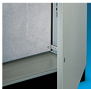
Placa de montaje de chapa de acero galvanizada de 2,5 mm de espesor regulable en profundidad.
